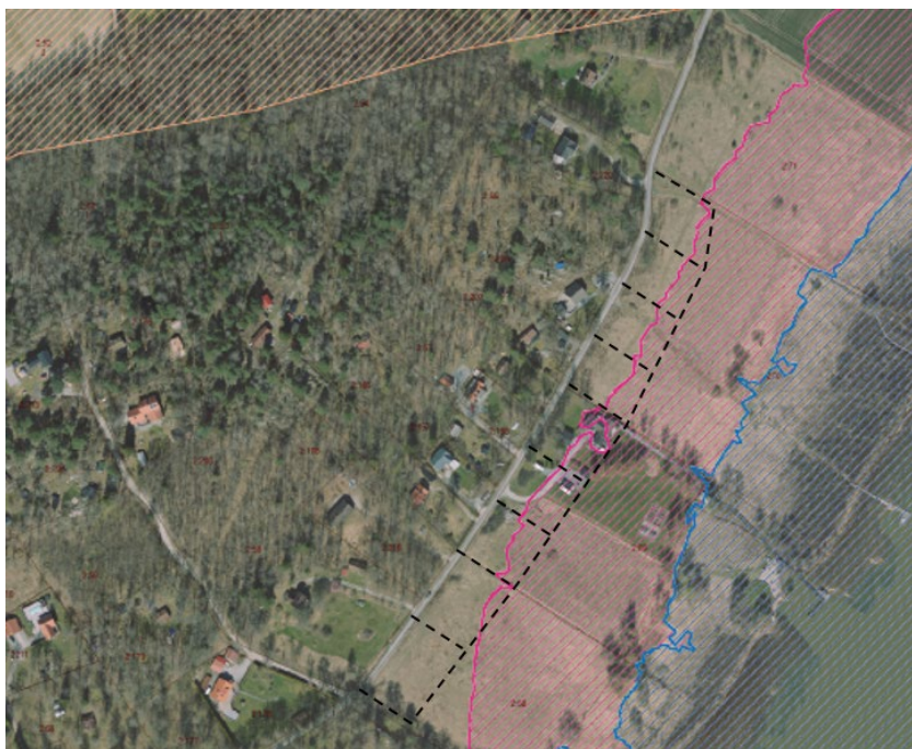
Figur 8 Illustrationen visar en ungefärlig skiss av hur nya fastigheter skulle kunna styckas av längs med Kornknarrsvägen. Rosa skraffering visar mark som ligger lägre än den rekommenderade lägsta grundläggningsnivån på 2,7 meter över havet (RH2000)
